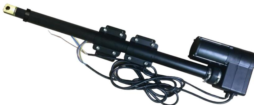
Привод линейный (далее сервопривод) является приводным устройством в системе управления микроклиматом животноводческого комплекса. В зависимости от алгоритма подключения, позволяет реализовать режимы открытия, закрытия различных клапанов, жалюзи, задвижек. При использовании режима с регулировкой, сервопривод является одним из ключевых элементов в системе подачи воздуха, при организации приточной или вытяжной вентиляции для обеспечения жизнедеятельности животных.
