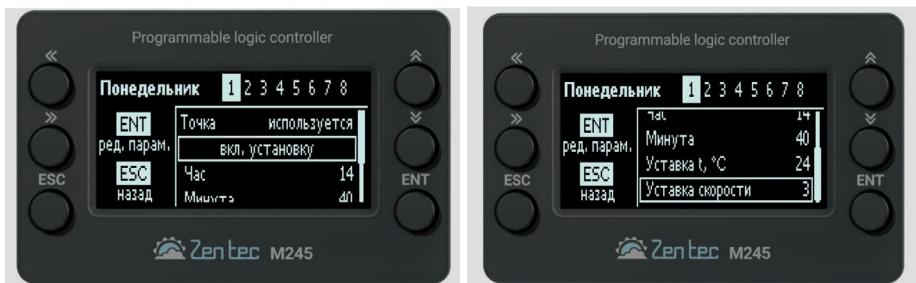
В подменю действия «1» указываем, что параметр «Точка» используется, выбираем, в каком состоянии должна быть установка (включаться или выключаться), указываем время, температуру уставки и требуемую скорость.
